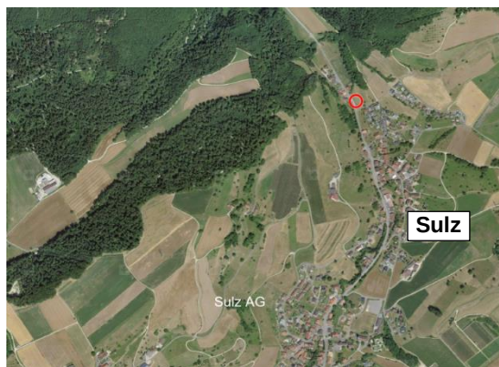
Kartenausschnitt: roter Kreis = Lage der Niederschlagsmessstation
