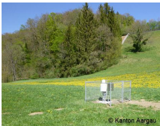
Automatisch registrierender Niederschlagsmesser
